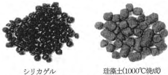
図4 油を吸収した多孔質物質の表面状態
