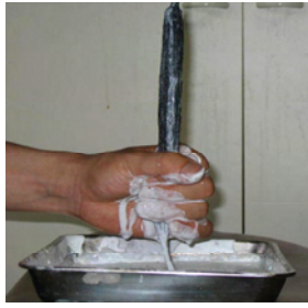
図2 シルク捨て耳へのPLAの含浸の様子
