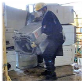
④省力設備の一例（洗濯機投入機）
