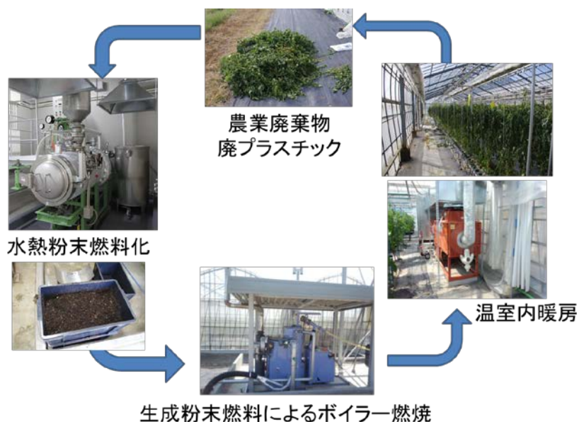
図4 プラスチックとバイオマスの混合廃棄物の固体燃料化
